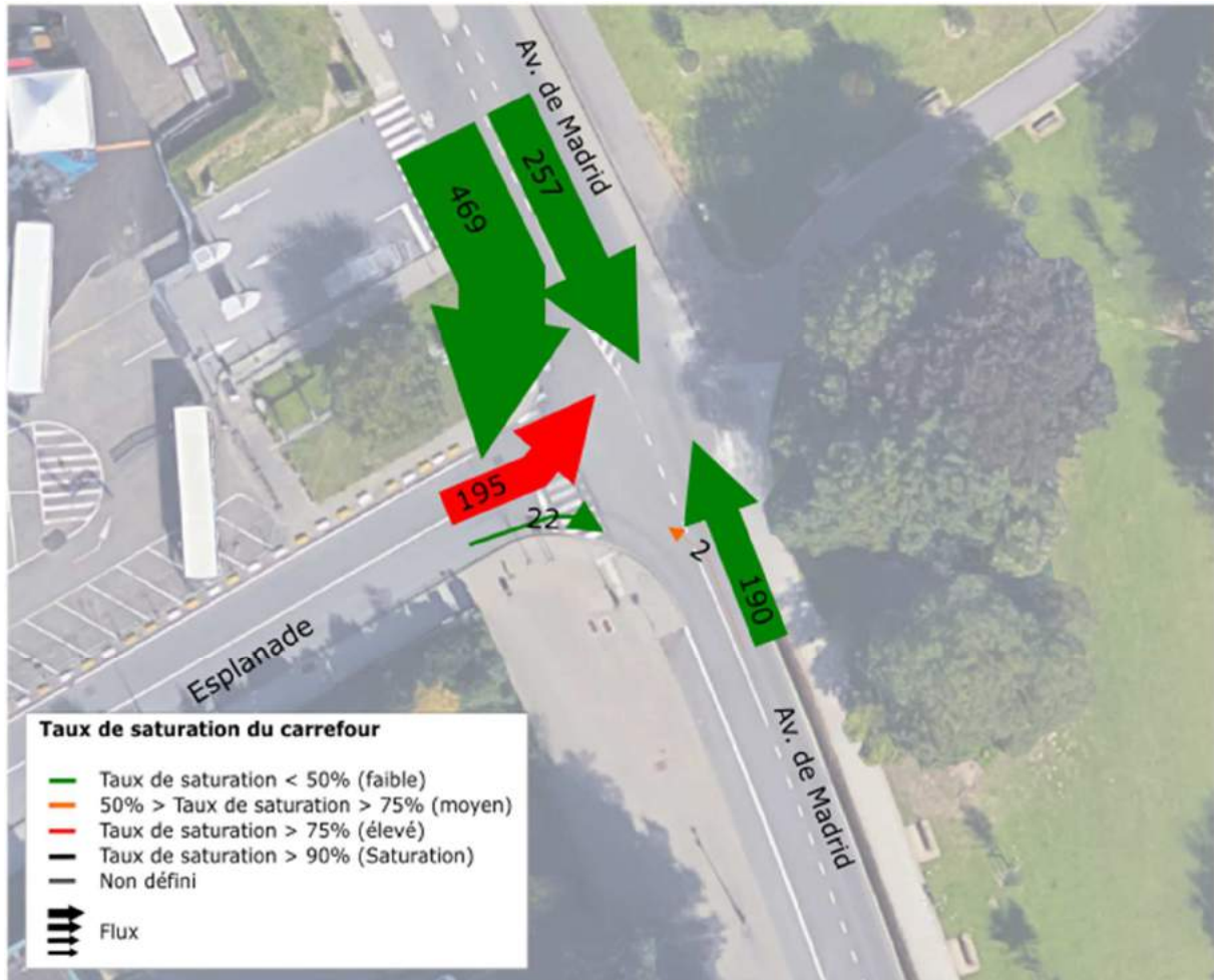
Figure 164 : Importance des flux et taux de saturation du carrefour entre l'avenue de Madrid et l'Esplanade en HPM (ARIES, 2016)
