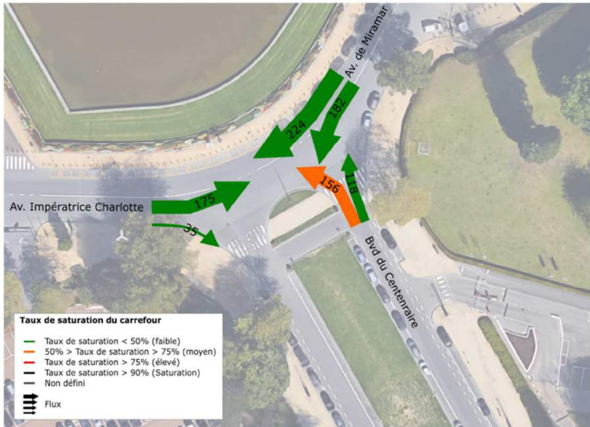
Figure 168 : Importance des flux et taux de saturation du carrefour entre les avenues Impératrice Charlotte – Miramar – Boulevard du Centenaire en HPS (ARIES, 2016)
